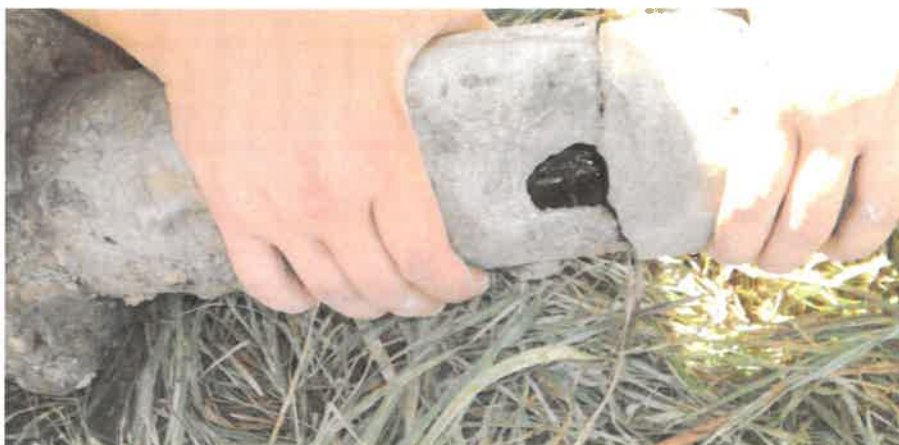
„Kicsattant” és „haránttöréses” AC cső
